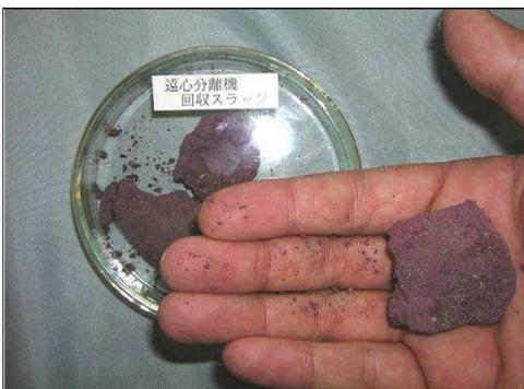
写真3. 微生物処理後(遠心分離回収)
